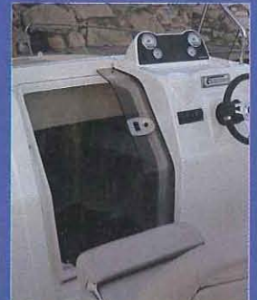
La cabine est accessible sur le côté bâbord de la console. Elle est dotée d'un portillon coulissant.
