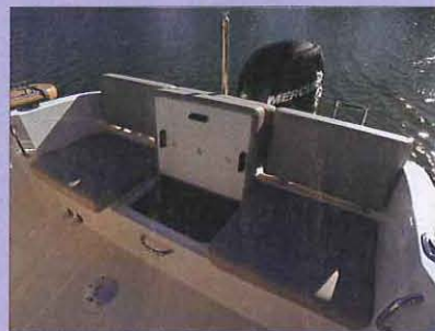
La baïlle à mouillage a de belles dimensions. Elle est équipée d'un taquet et dispose d'un rail guide mouillage vers le davier d'étrave. Un coffre se situe sous la banquette arrière.
