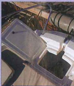
La baïlle à mouillage a de belles dimensions. Elle est équipée d'un taquet et dispose d'un rail guide mouillage vers le davier d'étrave. Un coffre se situe sous la banquette arrière.
