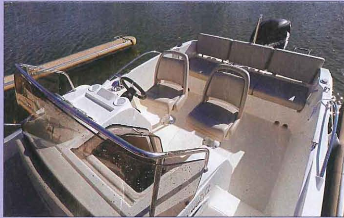
La profondeur du cockpit autovideur est importante à bord du Sundeck. La main courante surmontant le pare-brise sécurise l'accès à l'avant par le passavant bâbord.
