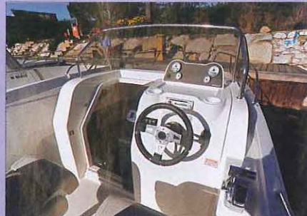
Le poste de pilotage décalé sur tribord est doté d'une commande des gaz électrique. Le tableau de bord dispose de place pour l'électronique. Un couchage existe dans la cabine.
